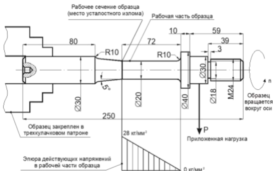
Рисунок 1. Схема нагружения испытываемого вала
