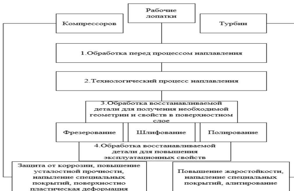
Рисунок 3. Общий технологический процесс восстановления и ремонта рабочих профилей лопаток ГТД
