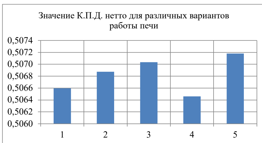
Рис. 1. Изменение К.П.Д. нетто без учета работы теплоутилизатора для различных вариантов работы нагревательной печи
