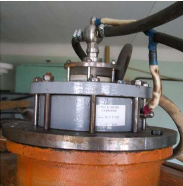
Рис. 3. Внешний вид ионного источника
