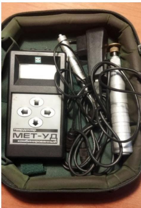
Рис. 2. Общий вид твердомера МЕТ-УД
