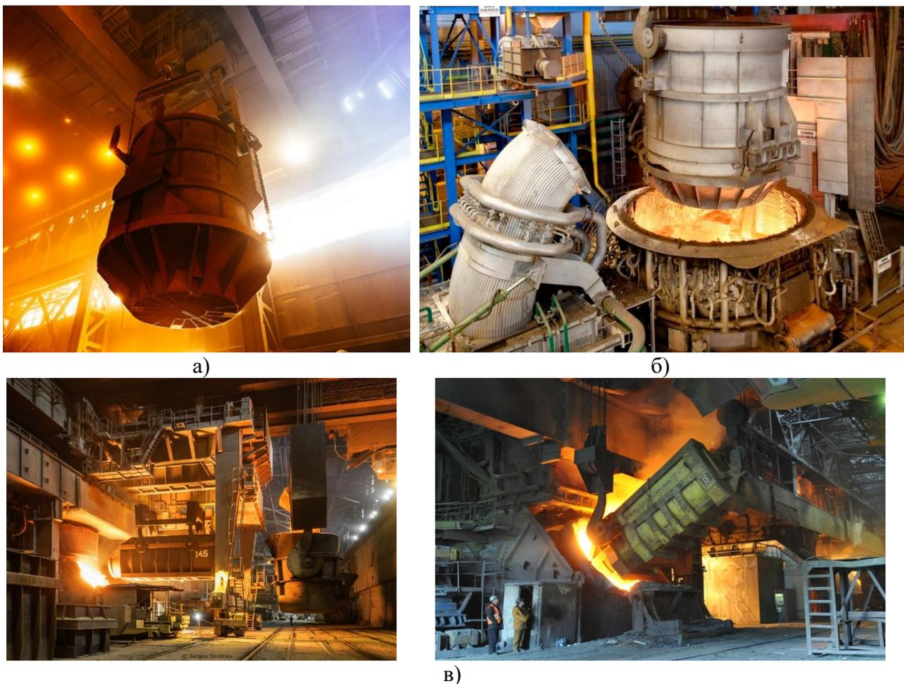
Рис. 1. Бадья перед загрузкой (а) и над электродуговой печью (б), завалка металлолома в конвертер (в)
