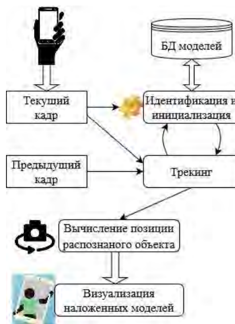
Рисунок 3 – Общий алгоритм для создания AR-приложения на базе пространственных или безмаркерных технологий
