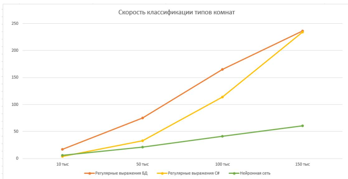
Рисунок 1 – График зависимости времени классификации от количества записей для различных подходов
