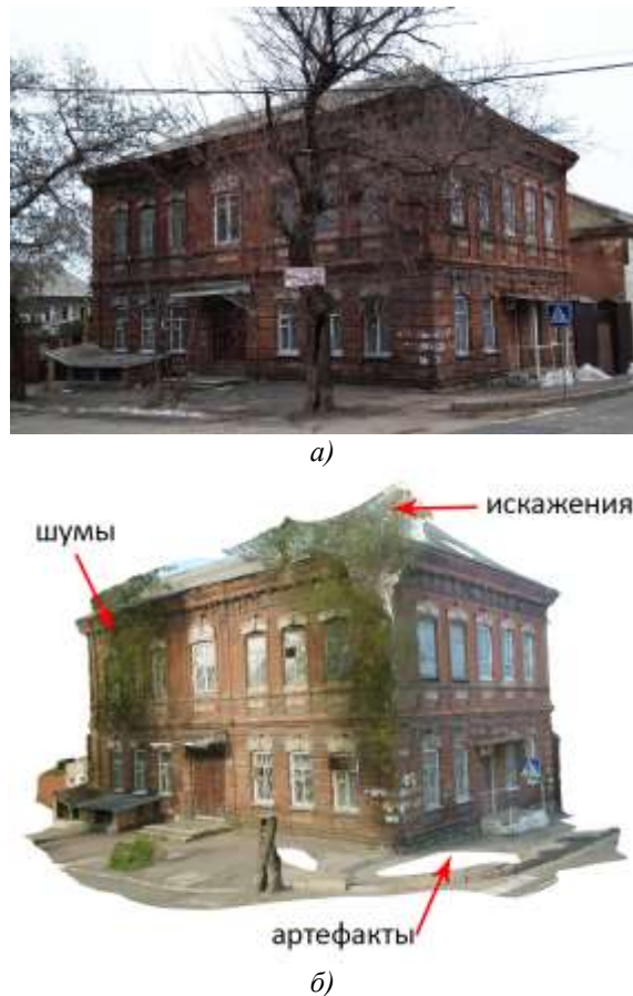
Рисунок 5 – Создание трехмерной модели объекта в фотограмметрическом редакторе: а) эталонный объект; б) трехмерная модель объекта.
