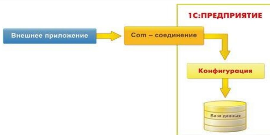
Рисунок 4 – Схема взаимодействия OLE Automation сервера с базой данных 1С:Предприятие
