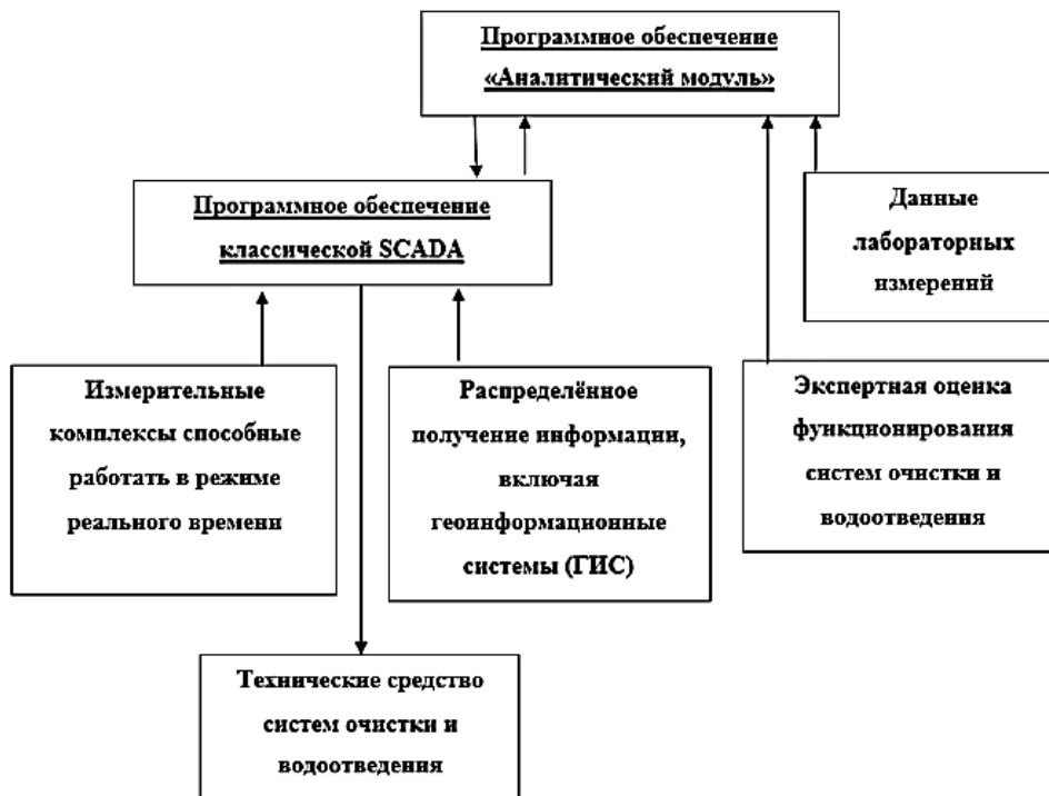
Рисунок 5 – Структура прикладного программного обеспечения интеллектуальной системы поддержки принятия решений водоотведения
