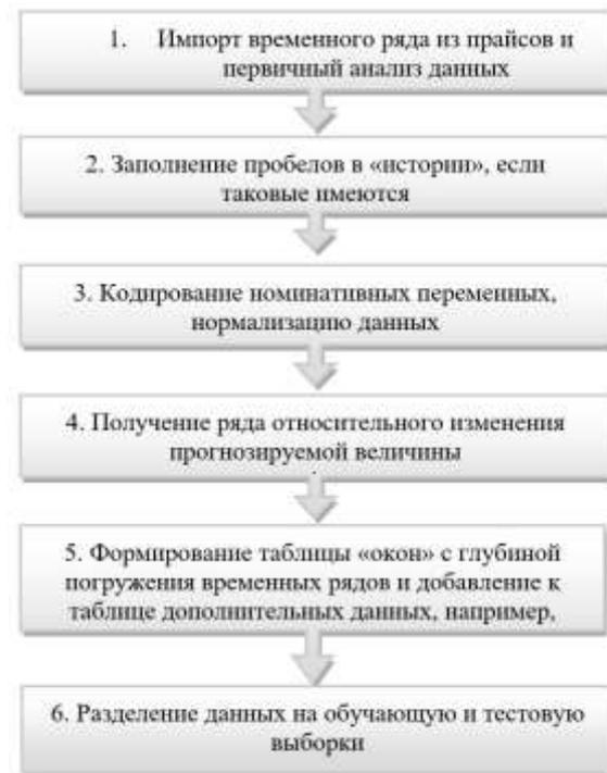
Рисунок 1 – Процесс предварительной обработки данных временного ряда
