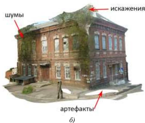
Рисунок 5 – Создание трехмерной модели объекта в фотограмметрическом редакторе: а) эталонный объект; б) трехмерная модель объекта.
