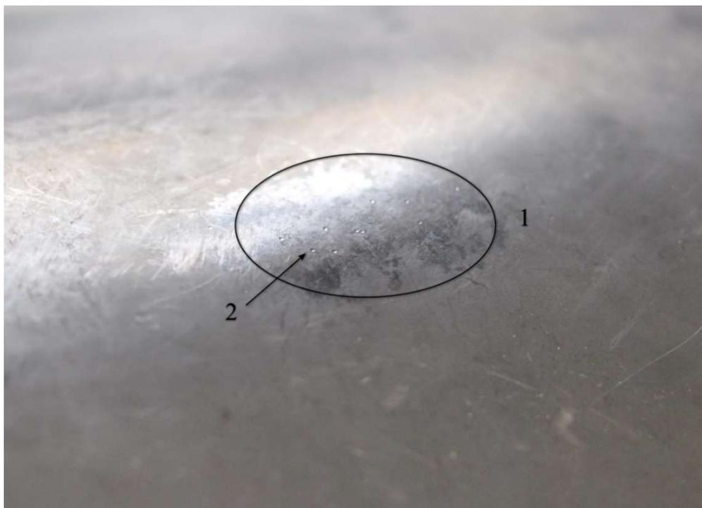
Рисунок 6. Упрочненная зона на контрольной заготовке:
