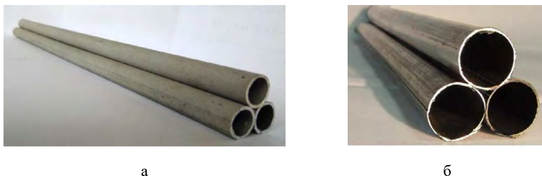
Рисунок 6. Образцы тонкостенных труб малого диаметра, разделенных на части с помощью механических (а) и гидравлических (б) лабораторных ножниц
