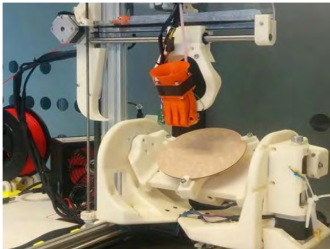
Рисунок 1. Вид 5-осевого 3D-принтера с подвижным в 3-х направлениях основанием
