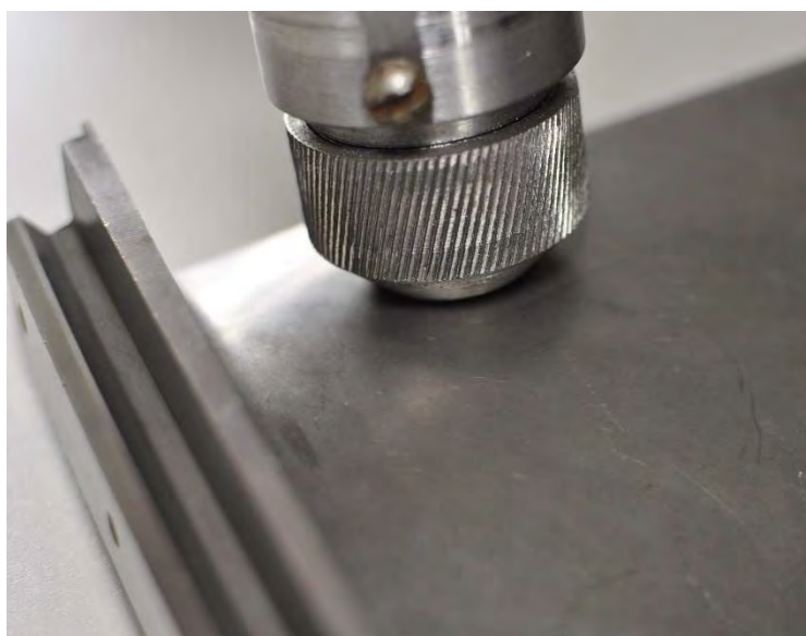
Рисунок 5. Зона контакта устройства ППУ и контрольного образца
