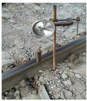
Рисунок 3 – Установка прогибомера на свайке
