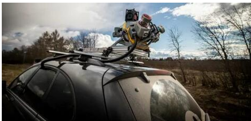
Рисунок 3 – Система мобильного картографирования Trimble MX9, установленная на легковом автомобиле
