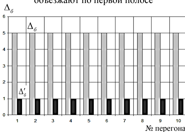
Рисунок 12 – Значения интервала безопасности \Delta_\delta между транспортными средствами после выполнения маневра объезда стоящего транспортного средства и интервала безопасности \Delta'_\delta между боковыми поверхностями
