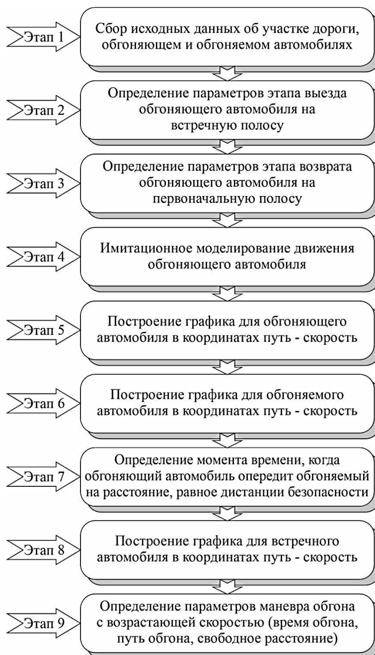
Рисунок 3 – Этапы методики определения параметров маневра обгона с возрастающей скоростью, основанной на имитационном моделировании движения обгоняющего автомобиля
