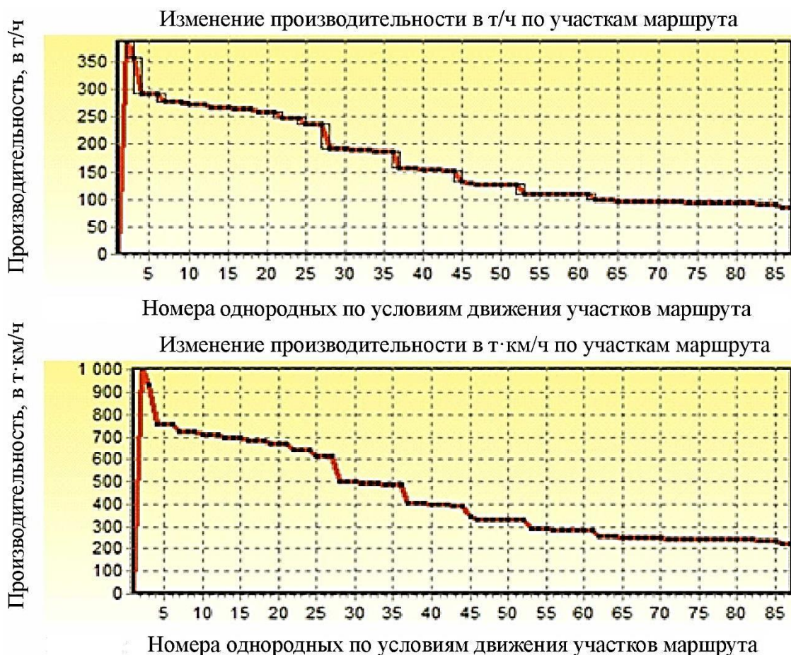
Рисунок 2 – Графики изменения производительности в тоннах в час и тонно-километрах в час на однородных по условиям движения участках маршрута
