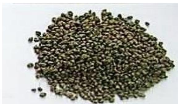
Рисунок 5 – Оплавленные неорганические гранулы грунта фракцией 1–2 мм
