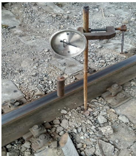
Рисунок 3 – Установка прогибомера на свайке
