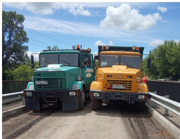
Рисунок 6 – Схема установки испытательной нагрузки
