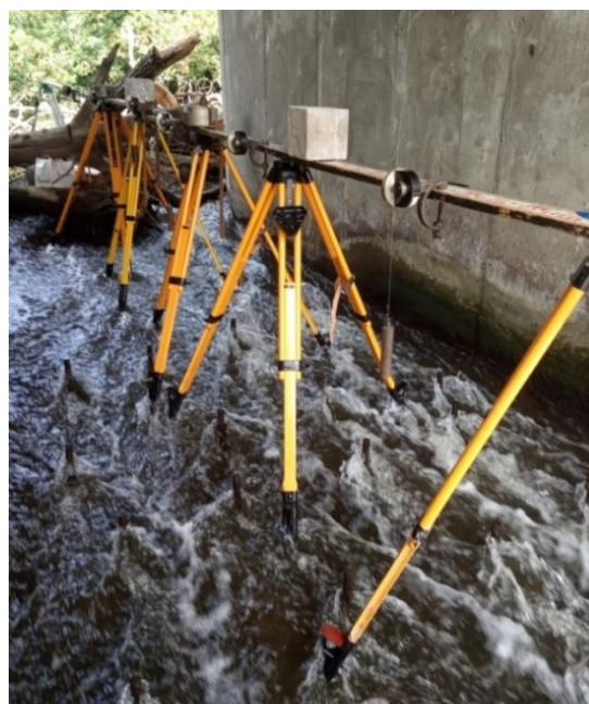
Рисунок 4 – Установка прогибомеров на специальной конструкции
