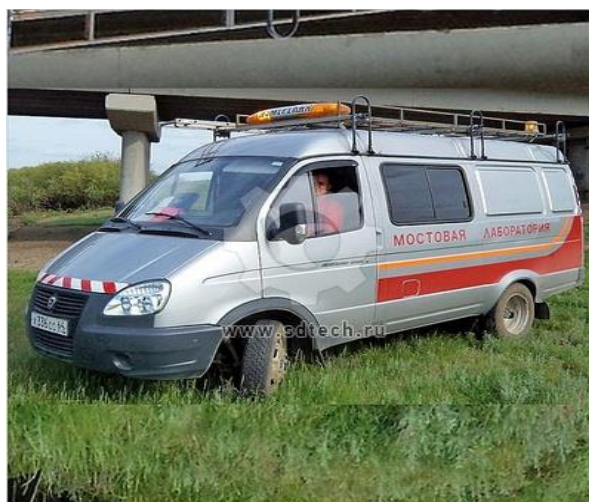
Рисунок 5 – Современная передвижная мостоиспытательная лаборатория КП-532
