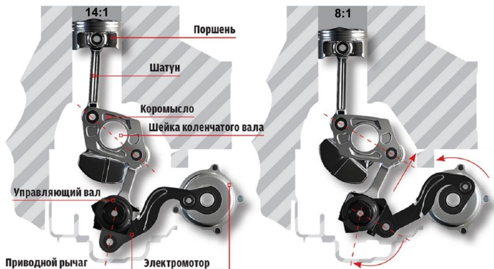
Рисунок 5 – Механизм изменения степени сжатия в двигателе VC-Turbo
