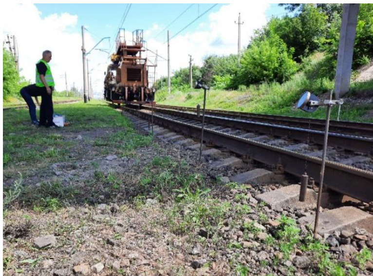
Рисунок 3 – Размещение прогибомеров ПМ-3 под пролетом
