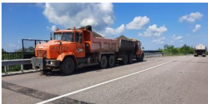
Рисунок 5 – Размещение испытательной нагрузки по схемам 1 и 3
