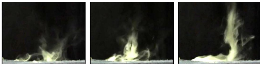
Рисунок 9 – Характерные картины образования устойчивого вихря, генерируемого узлом безлопастного вентилятора
