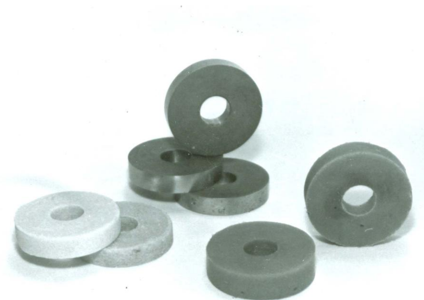
Рисунок 2. Образцы-ролики из материалов абразивных зубчатых хонов и стальных зубчатых колёс
