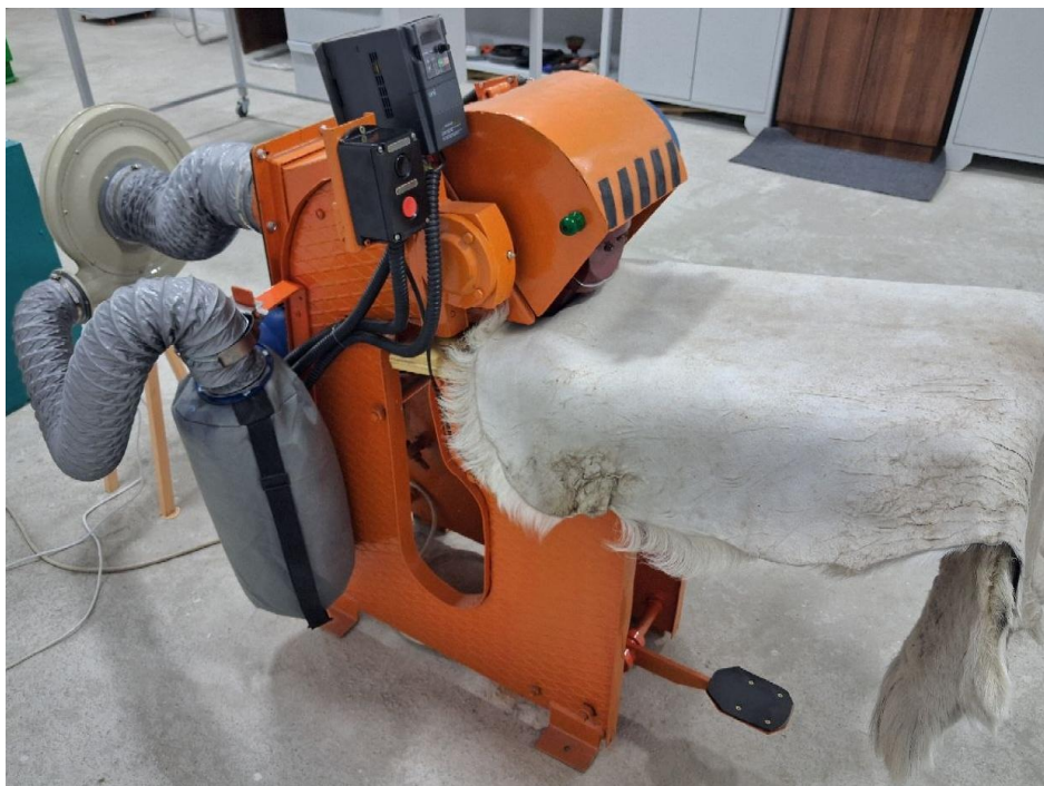
Рисунок 6. Общий вид разбивочной машины с устройством улавливания кожной пыли (ИМСС АН РУЗ)
