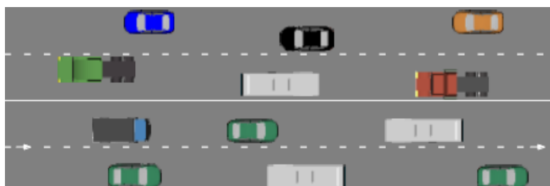
Рисунок 5 – Формирование условий движения ПМТ на четырехполосном перегоне УДС, где зависимость скорости потока от плотности определяется на двух полосах движения
