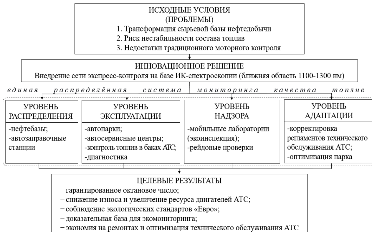
Рисунок – Концептуальная модель системы оперативного контроля качества топлив для обеспечения эксплуатационной и экологической безопасности автомобильного транспорта в условиях использования трудноизвлекаемых запасов углеводородов
