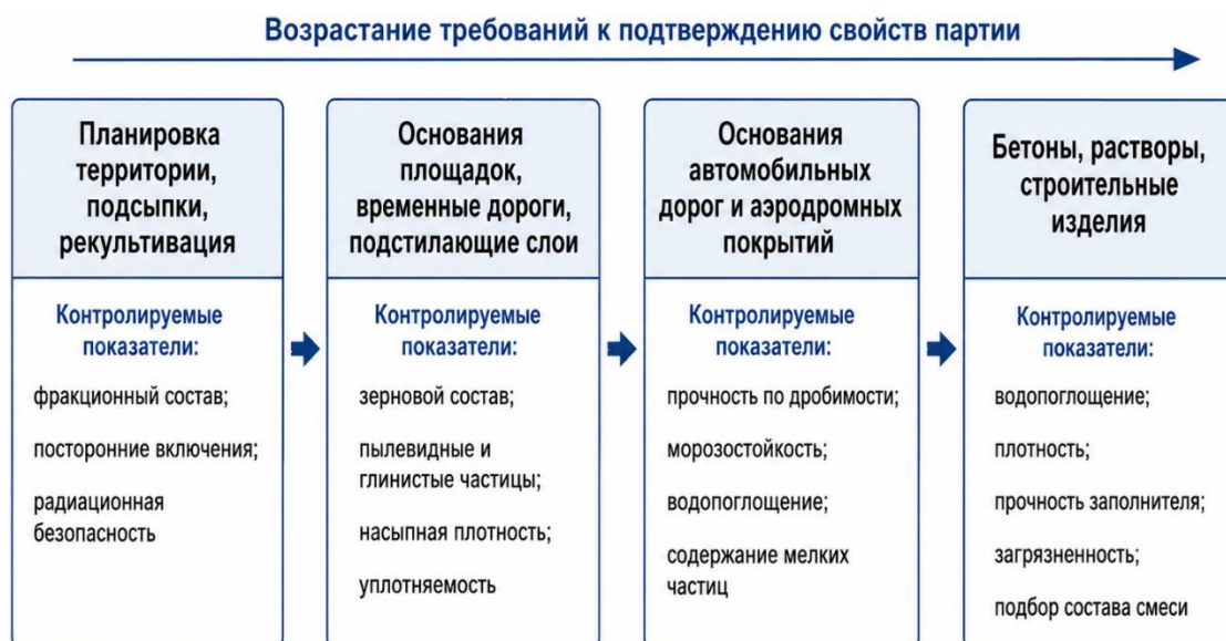
Рисунок 3 – Каскадное назначение области применения вторичных материалов с учётом контролируемых показателей качества
